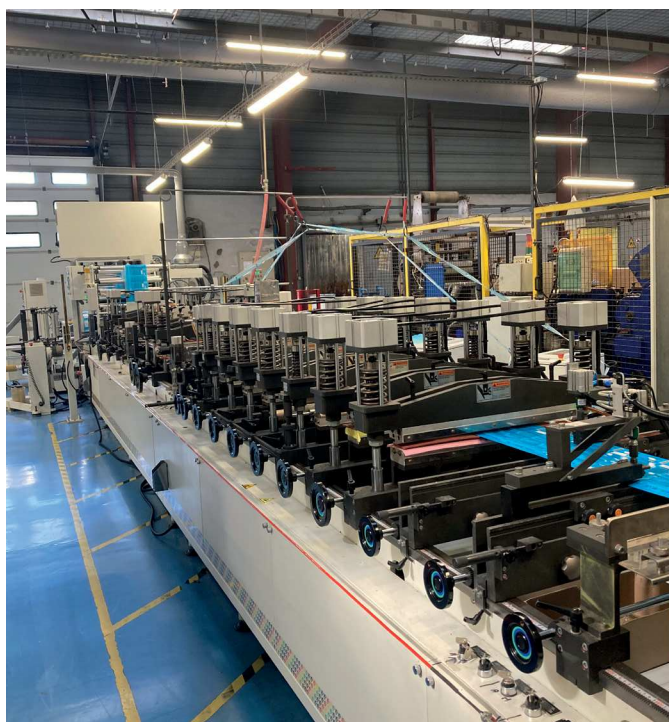
Machine de façonnage Doypack de marque Dahbah.
